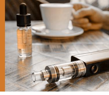
La vapoteuse comprend une batterie apportant l'énergie nécessaire à chauffer une résistance qui va permettre la production d'un aérosol à partir du liquide contenu dans la vapoteuse. Les liquides sont composés d'un solvant organique (propylène glycol et/ou de la glycérine végétale), d'arômes et dans la majorité des cas de nicotine avec une concentration maximale de 20 mg/ml. C'est l'aspiration par l'usager qui déclenche la production de l'aérosol inhalé.
